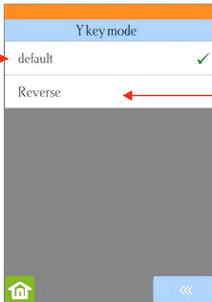
Al presionar una flecha ARRIBA se moverá el material hacia la parte posterior del cortador
