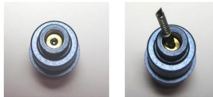
Guía suavemente la tapa sobre la parte superior de la cuchilla y luego puede comenzar a atornillar la tapa. NO trate de forzarla. Puede que tenga que mover la tapa ligeramente en el resorte para colocarlo y para la tapa para atornillar en la parte principal del soporte de la cuchilla:
