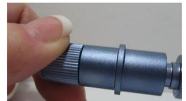
Tornillo de la tapa firmemente. Luego, a medida que el tornillo de la parte principal del soporte de la cuchilla (la parte superior), la cuchilla comenzará a mostrar a través del agujero en la tapa. Sólo necesita un poco de cuchilla expuesta como sea necesario para penetrar el material que se está cortando. Más cuchilla no se traduce en un mejor corte. De hecho, el opuesto es cierto.
