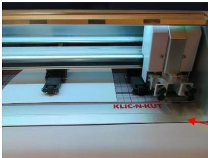
Sólo la parte inferior del tapete debe estar en la parte frontal del cortador.
